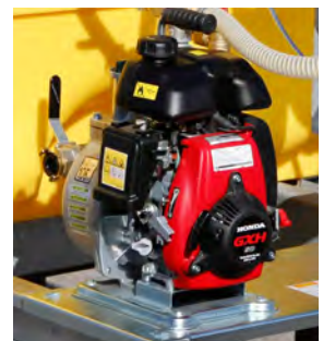
Bomba Honda con motor de gasolina 130 L/min
