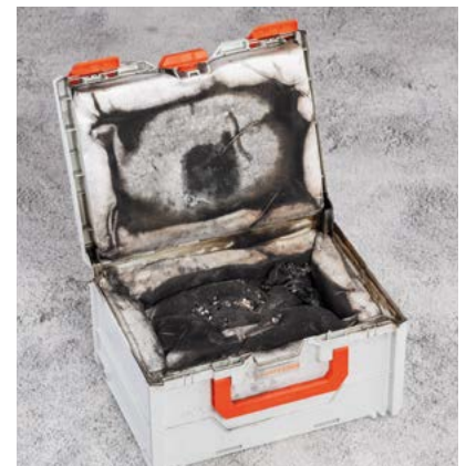
Erfolgreicher Brandversuch: die CEMO Brandschutzbox hält.
